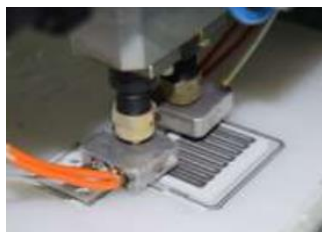
Рисунок 9 – Демонстрация одновременного построения керамической изолирующей подложки методом микроэкструзии и нагревательного элемента из коррозионно-стойкой стали методом FFF [15]
