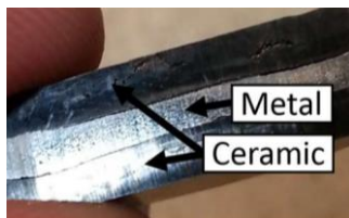
Рисунок 8 – Пример получения композита «керамика1-металл-керамика2» методом ТЗДР
