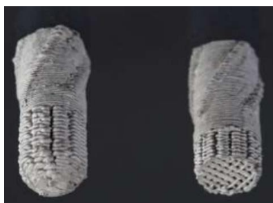
Рисунок 3 – Дентальные имплантаты, сформованные методом FFF из композиционного (смесь порошков стали 316L и диоксида циркония TZ-3Y-E) филамента марки РЕВАХ 55 [12]
