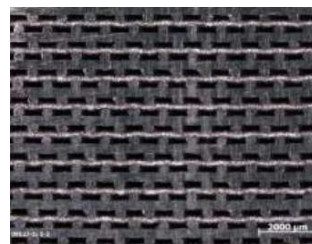
Рисунок 5 – Вид сверху образца макропористого материала, полученного методом микроэкструзии пасты, наполненной порошком Ti-6Al-4V [14]
