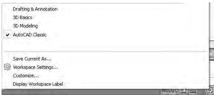
Рис. 1.4. Меню кнопки Переключение рабочих пространств (Workspace Switching)
