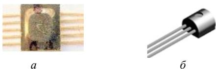
Рисунок 1 – Вид микросхем 5318EP-015 (а) и KP1181EH5A (б)
