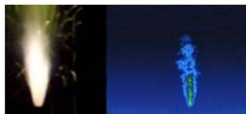
Рисунок 4 – Сравнение изображений пламени камерами видимого диапазона 0.4 – 0.8 мкм и ИК-диапазона 3 .. 5 мкм
