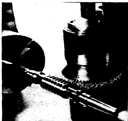
Рис. 4.15. Схема (а) и рабочая зона станка (б) для МАП винтов и червяков: 1 – полюсной наконечник; 2 – ферроабразивный порошок; 3 – полируемая деталь
