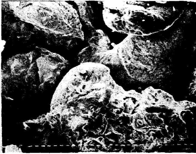
Рис. 5.15. Морфология частиц ФАП Fe-Al-Si-Cr (увеличение \times 160 )
