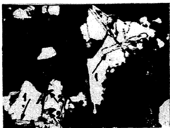
Микроструктура зерен ферроабразива фракции 315...160 мкм с 20% TiB_2 . Матрица из Fe, В, С сплава, кристаллические фазы: бориды титана ( \times 100 )
