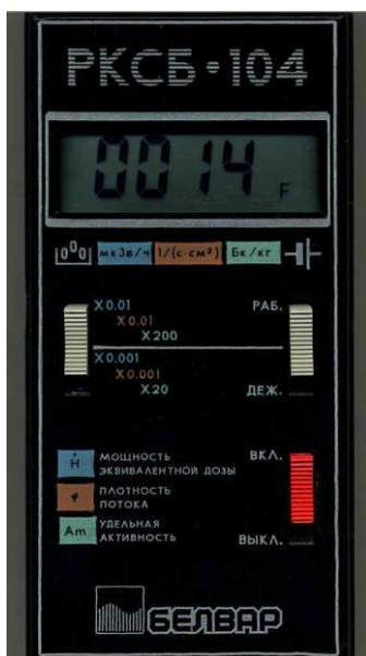
Рисунок 1 – Общий вид рабочей панели дозиметра-радиометра РКСБ-104
