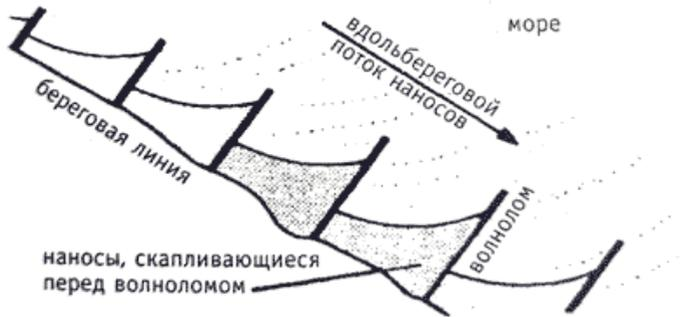
Рис. 1.14. Схема расположения бун и перехвата вдольберегового потока наносов
