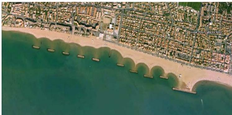
Рис. 1.21. Формирование пляжа естественным потоком наносов с помощью приливистых волноломов, салиентов и томболо
