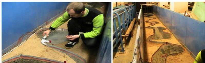
Рис. 2.13. Проведение исследований внутриводоемных течений на модели каскада водохранилищ ВМВС
