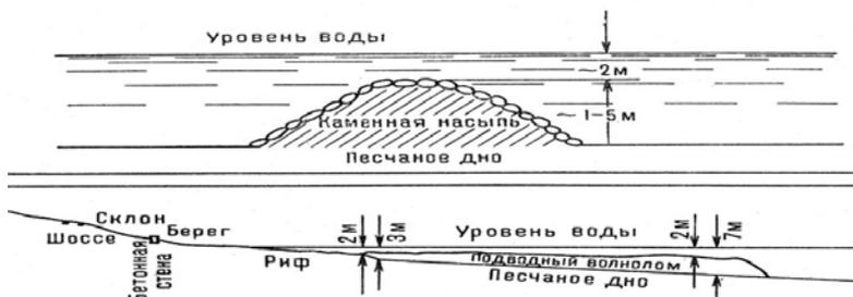
Рис. 1.5. Схема установки подводного волнолома
