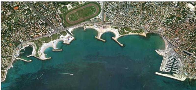
Рис. 1.20. Франция. Марсель. Искусственный пляж, созданный методом строительства искусственных мысов из горной массы
