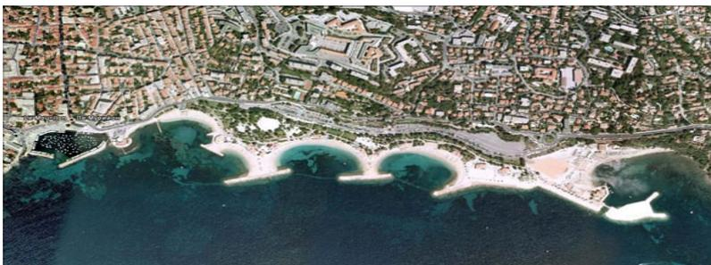
Рис. 1.6. Создание и защита пляжей, образованных с помощью волноломов
