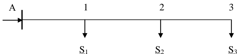
Рис. 24. Схема распределительной сети напряжением 10 кВ
