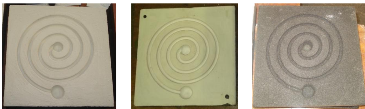
а – противопопригарное покрытие, модифицированное наноструктурированным бемитом; б – противопопригарное покрытие без модификатора; в – неокрашенная форма
