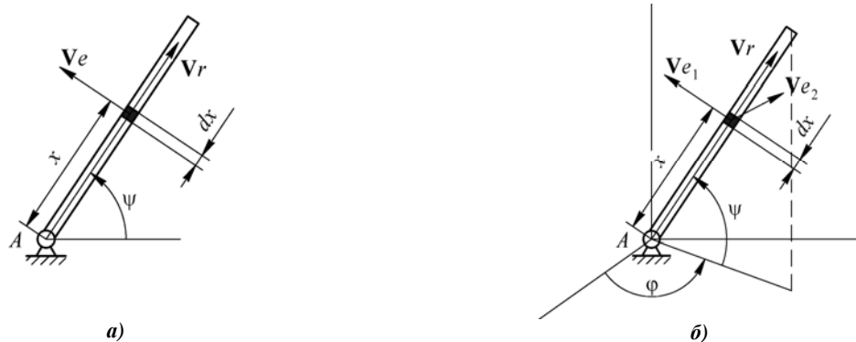
Рисунок 1. – Кинематика стержня, участвующего во вращательном (а) и сферическом (б) движении
