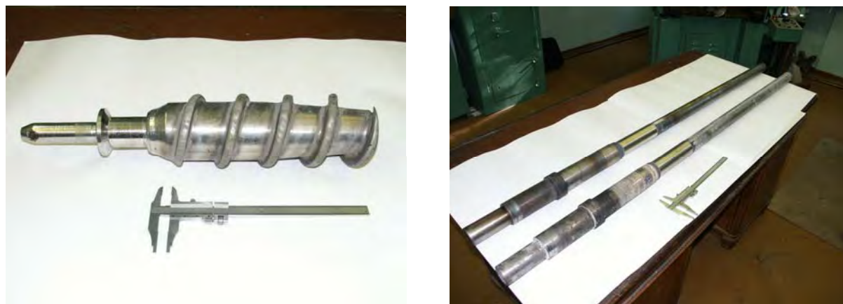
Рисунок 1. – Восстановленные валы и шнеки насосов
