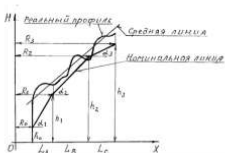
Рисунок 1 – Продольный профиль изношенного седла клапана
