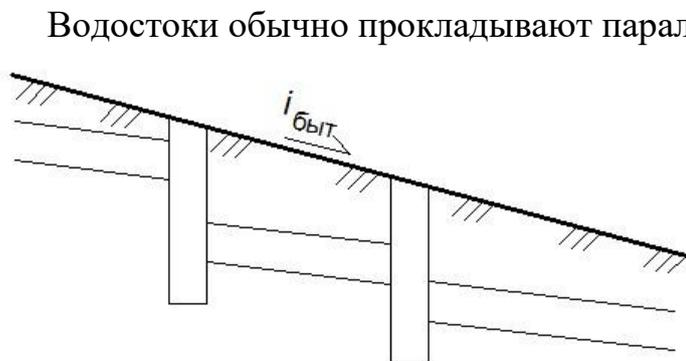
Водостоки обычно прокладывают параллельно поверхности земли, при больших уклонах местности возможно применение перепадных колодцев, быстротоков, применение вместо железобетонных труб металлических.
