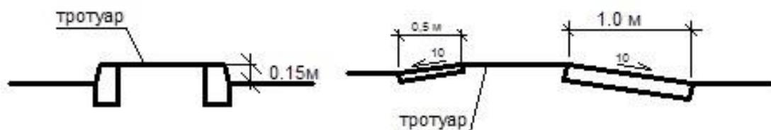
Центральные разделительные полосы следует устраивать на магистральных улицах и дорогах **категорий М, А6, Д4** согласно таблице 6.1. В стесненных условиях допускается ширину центральной разделительной полосы на улицах и дорогах **категорий М и Д4** уменьшать до ширины, необходимой для установки парапетных или металлических ограждений с учетом их прогиба плюс **1,0** м с каждой их стороны. На магистральных улицах и дорогах катего-
