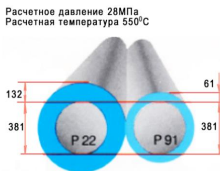
Рисунок 1 – Сравнение толщин стенок труб из теплоустойчивой P22 (ближайший аналог 12X2М) и жаропрочной стали P91(ближайший аналог 10X9МФБ).
