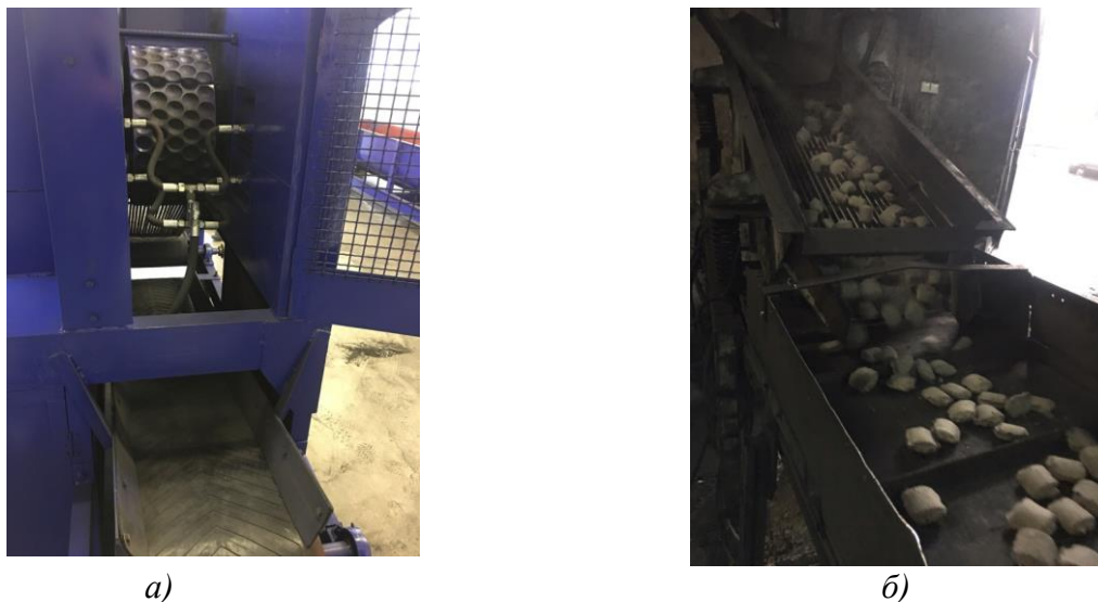
Рисунок 2 – Валковый пресс для получения брикетов разжижителя на основе ОПВА: а – валковый пресс; б – брикеты на основе ОПВА
