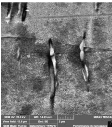
Рисунок 1 – Волокна, формируемые частицами свинца в режиме сверхглубокого проникания
