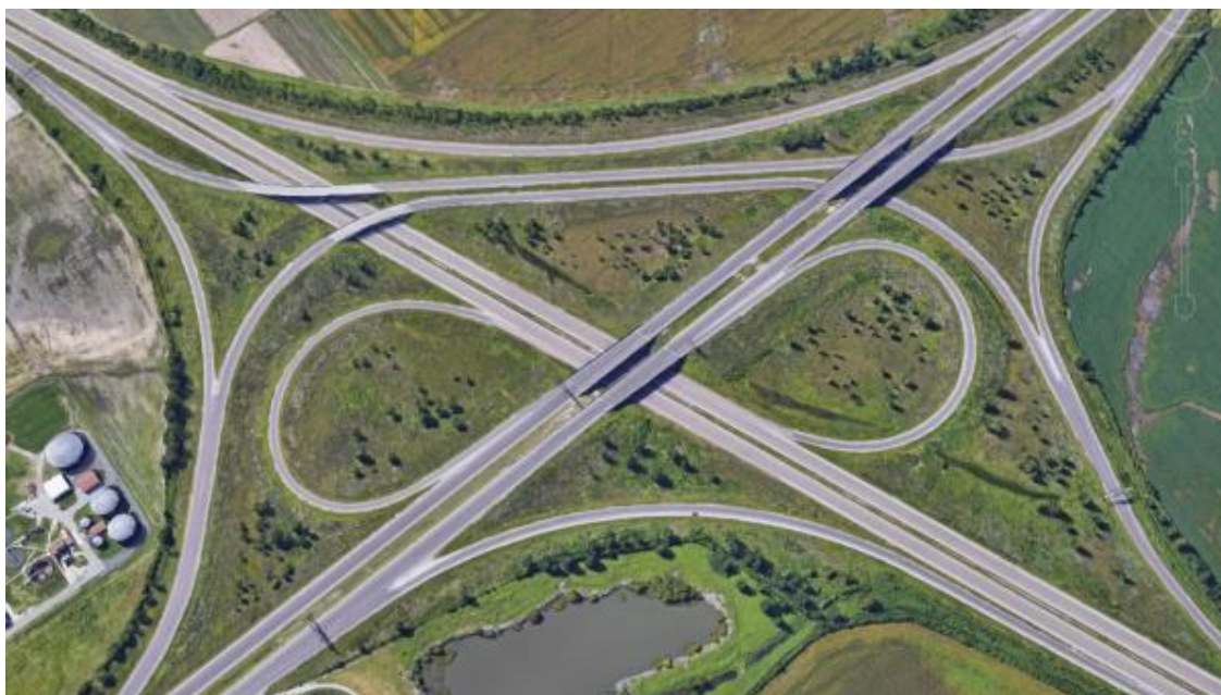
Рис. 1.17. Улучшенная транспортная развязка «клеверный лист» с заменой двух петлеобразных ЛПО на полупрямые огибающее и направленное .
