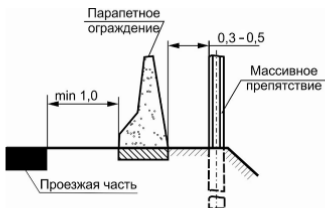
Рис.2.11.5. Расположение недеформируемого дорожного ограждения возле массивного препятствия.
