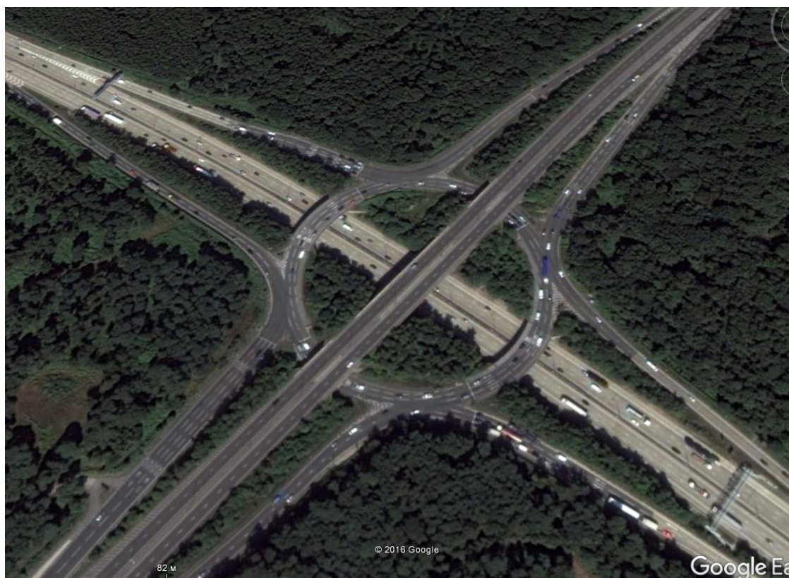
Рис. 1.10. Транспортная развязка «распределительное кольцо с пятью путепроводами».
