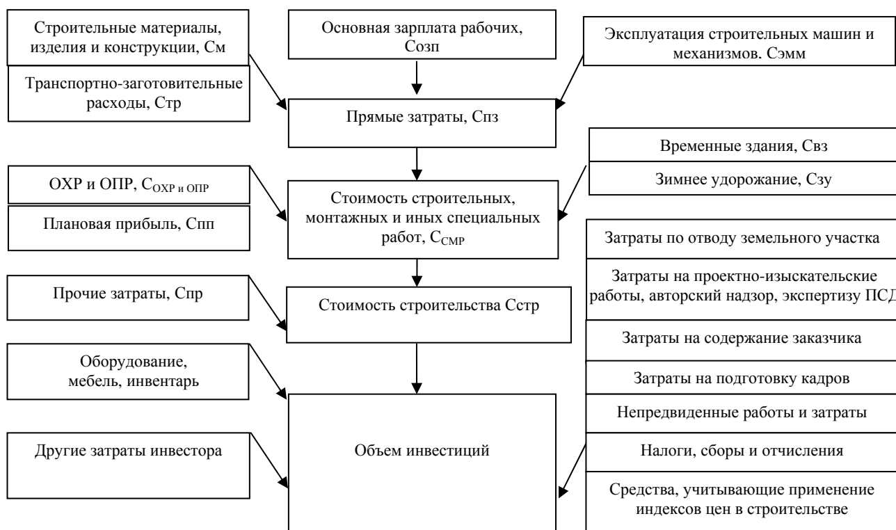
Рис. 15.1 Порядок формирования стоимости строительства
