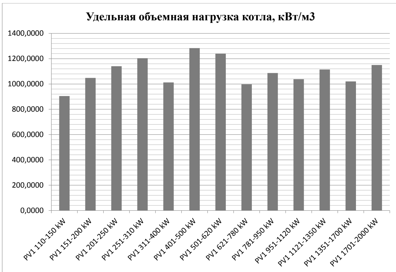
Рисунок 1. Удельная объемная нагрузка котлов VISSMANN серии VITOPLEX 100 тип PV1
