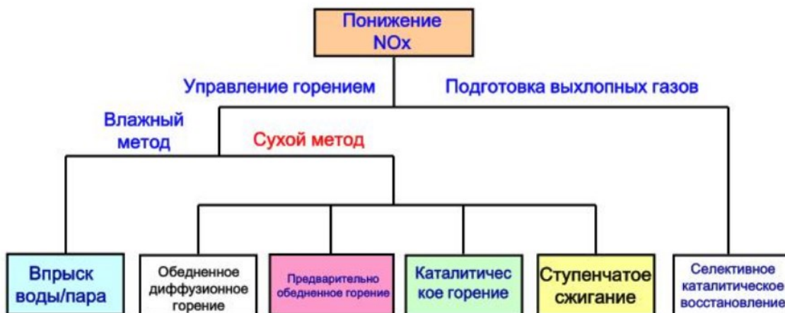
Рисунок 3. Основные методы снижения образования NO_x .
