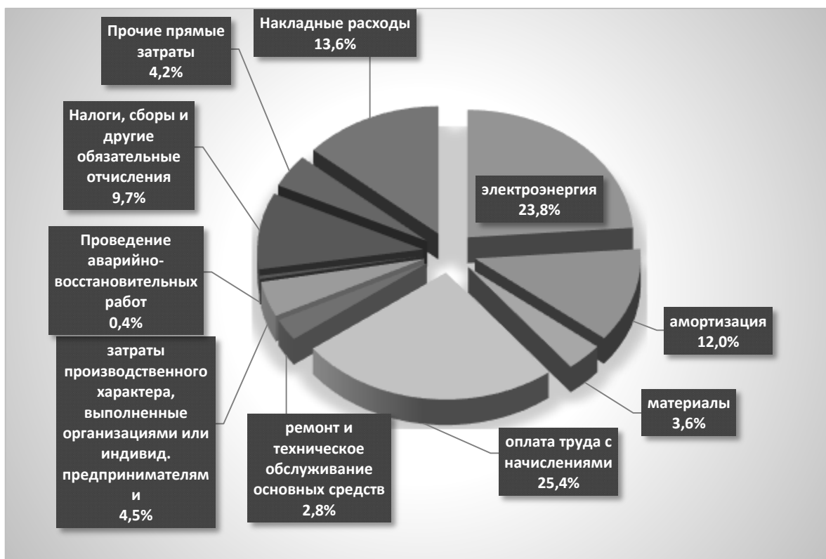
Рис. 3.9. Структура затрат средней себестоимости (по элементам затрат) 1 м 3 воды предприятий ВКХ (ЖКХ) в целом по Минской области по итогам 2016 г. Источник : Данные предприятий ВКХ (ЖКХ) Минской области
