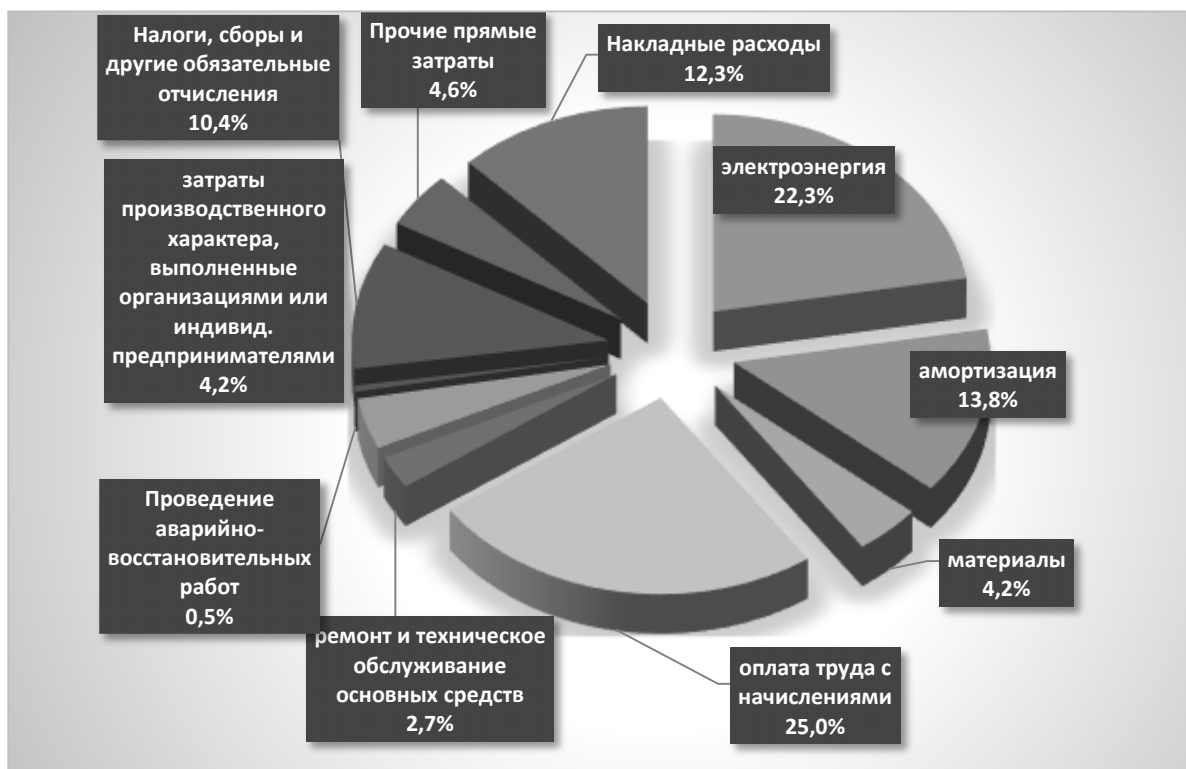
Рис. 3.10. Структура средней себестоимости (по элементам затрат) 1 м 3 воды предприятий ВКХ (ЖКХ) в целом по Минской области по итогам 2017 г. Источник: Данные предприятий ВКХ (ЖКХ) Минской области
