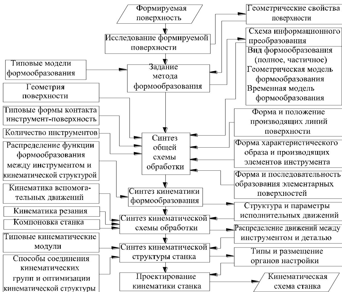
Рис. 2. Этапы синтеза кинематической схемы станка
