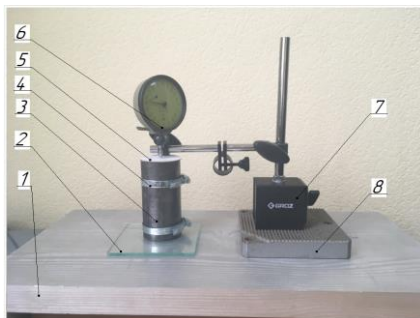
Рис. 1. Фотография общего вида устройства определения линейного расширения стоматологического гипса
