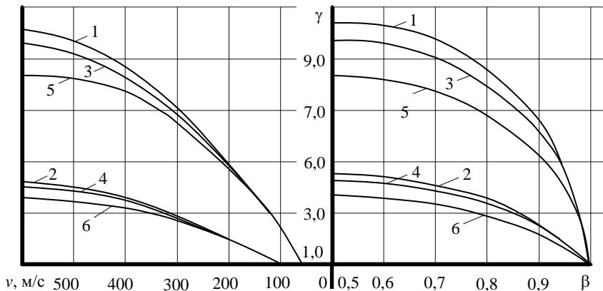
*Rис. 2. Скорость газа на выходе из направляющего аппарата:*
