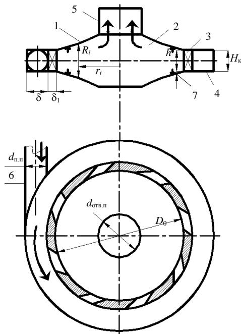
*Рис. 1. Вихревое смесительное устройство: 1 – корпус смесителя; 2 – камера смешения газа и воды; 3 – направляющий аппарат; 4 – раздающая камера; 5 – туманоотводящий патрубок; 6 – патрубок для отвода газа; 7 – форсунки для подвода воды*
