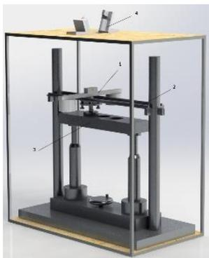
Физический маятник с опорой качения, совершающий свободные затухающие колебания, широко используется при исследованиях трения качения [1, 2]. Однако использование маятника с опорой на два шарика имеет существенный недостаток: требуется два идентичных шарика и два идентичных образца.
