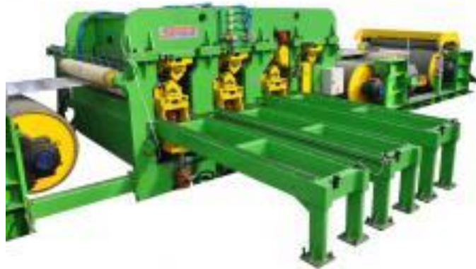
Рисунок 2.29 – Правильно-растяжная машина (стол-рольганг)
