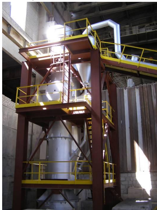
Опытно-промышленная печь циклонного типа
