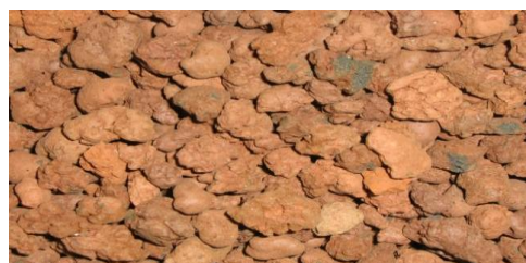
Рисунок 2 – Керамзит, полученный с использованием шламов гальванического производства
