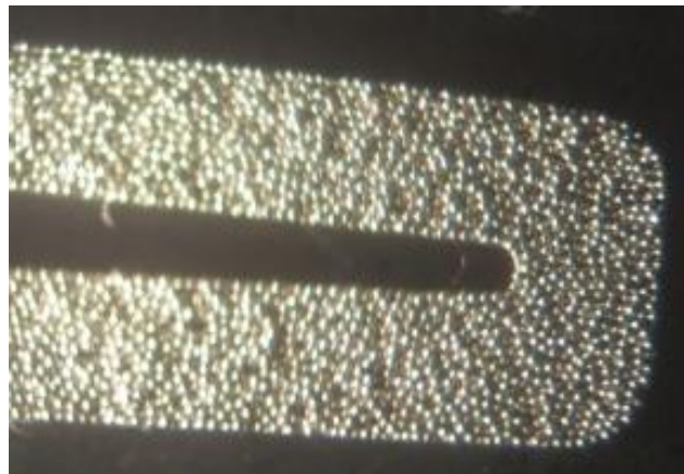
Фото теплообменника с пористым теплоотводящим элементом и фото пористого образца
