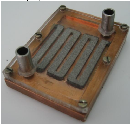
Фото теплообменника с пористым теплоотводящим элементом и фото пористого образца
