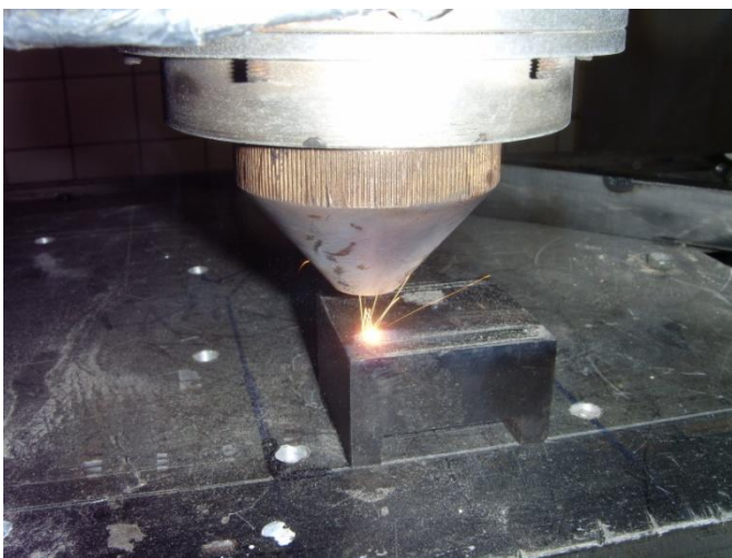
Рисунок 2- Процесс лазерной наплавки
