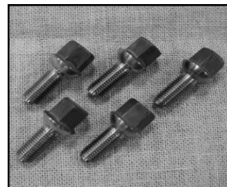
Болты М14, сплав VT16
