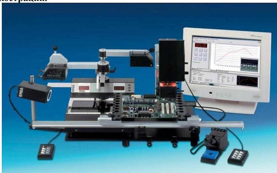
Рисунок 1 – Состав инфракрасного паяльного комплекса
