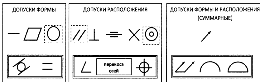
Рисунок 1 – Общие допуски формы и расположения поверхностей (ненормируемые [3] приведены в двойной рамке, не попавшие в перечень – в штриховой).
