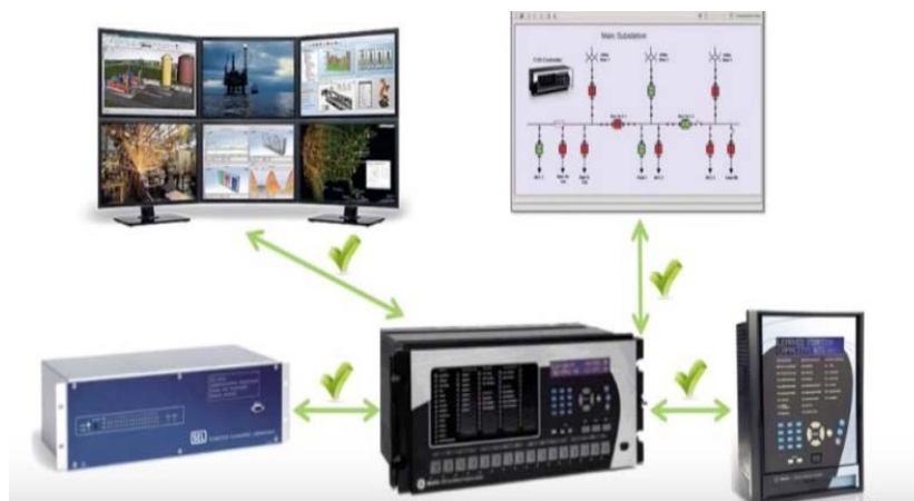
Рис. 1. МЭК-104 в структуре телеметрической системы.
