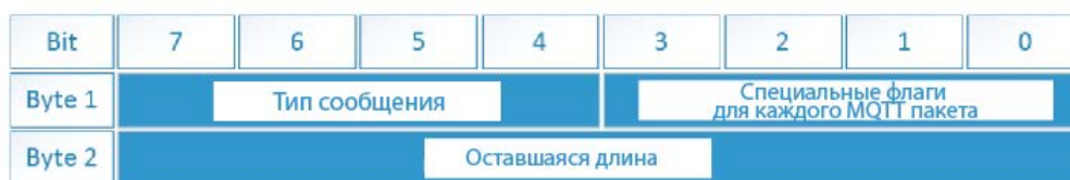
Рис. 1. Структура фиксированного заголовка.
