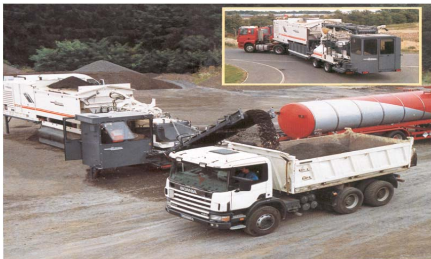
Рис. 10.2. Мобильная установка по приготовлению бетонов на ОГВ: вверху – в транспортном состоянии; внизу – в развернутом состоянии
