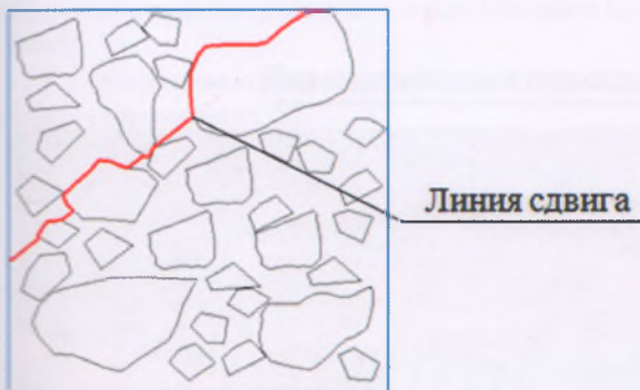
Рисунок 1 – Модель структуры асфальтобетона с построенной линией сдвига
