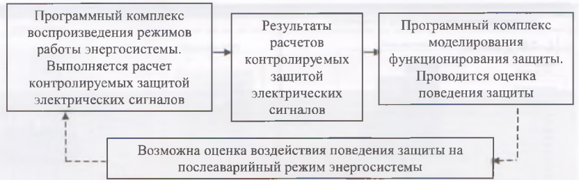
Рис. 1. Взаимодействие программных комплексов при цифровом моделировании защиты
