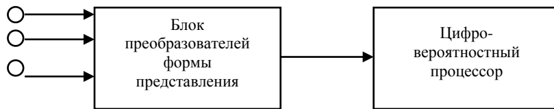
Рис. 1. Схема измерительного контроллера
