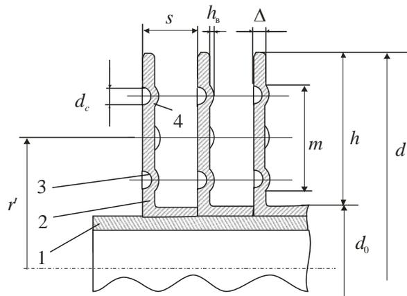
Рис. 2. Биметаллическая труба с KLM-ребрами со сферическими лунками
