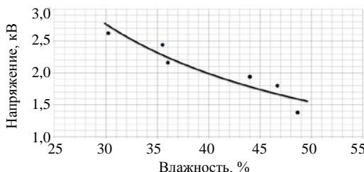
*Рис. 2.* Зависимость величины потенциала ЭСР от влажности в помещении РЩ с фальшполом (точками указаны результаты измерения на отдельных ПС; сплошной линией – аппроксимирующая функция)
