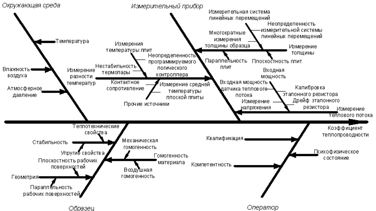
Рисунок 6 – Диаграмма «причина-следствие» с источниками изменчивости при измерении \lambda материалов с помощью прибора HFM 436
