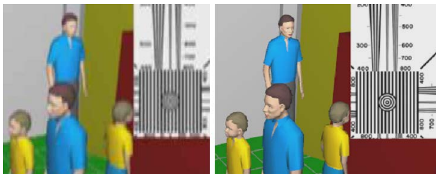
Рисунок 1.8 – Фрагмент модели изображения в реальном масштабе с учётом реального качества записанных кадров (слева) и фрагмент модели изображения без учёта реального качества (справа)
