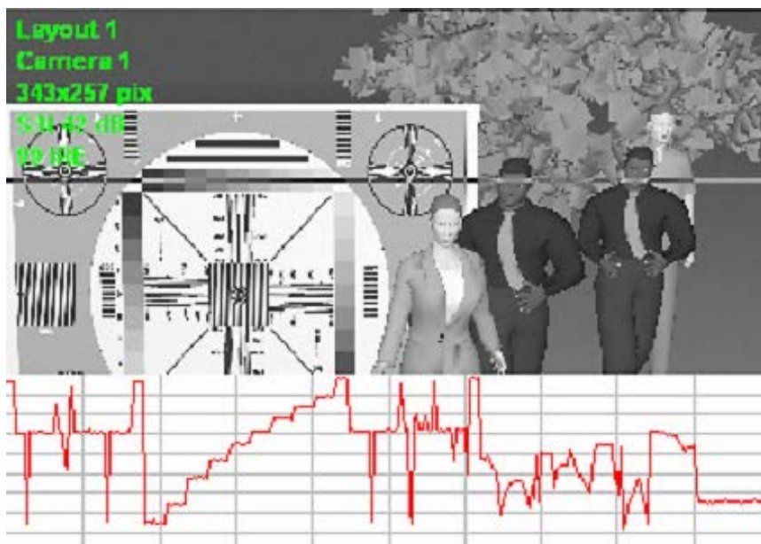
Рисунок 2.8 – Изображение и видеосигнал при высокой освещенности сцены
