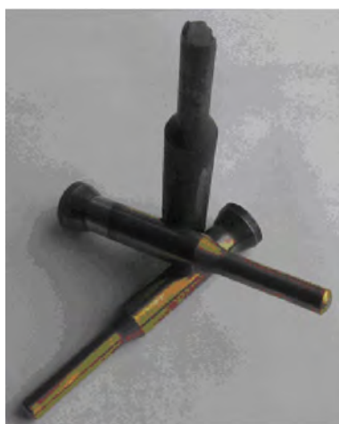
Рис. 5. Пуансон обратного выдавливания ниппеля шлангового держателя
