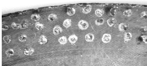
Рисунок 7 — Фотография участка поверхности диска: а — после модифицирования; б — после распиливания им образцов площадью 325 мм 2
