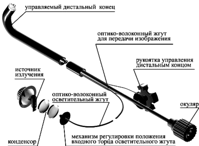
Рис. 5.13. Оптико-механическая схема эндоскопа
