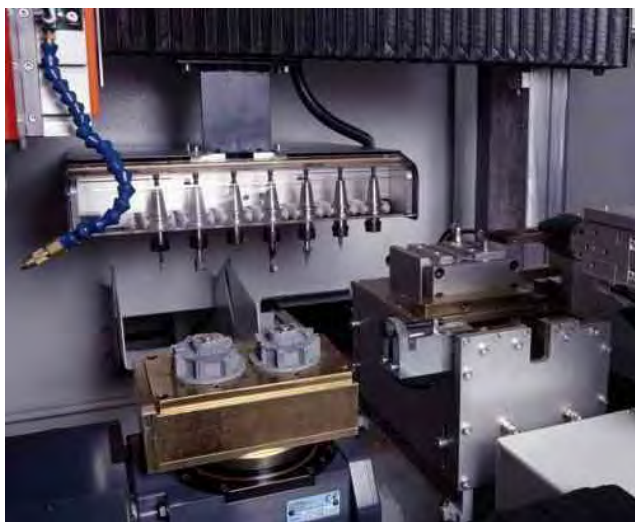
Рис. 3.6. Обрабатывающий центр, предназначенный для производства фрезерованных пластмассовых оправ: a – фотография общего вида; б – фотография зоны обработки, включая шпиндели, а также приспособления для закрепления заготовки оправы
