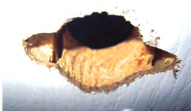
Рис. 12. Внутреннее заполнение двери без категории сопротивления взлому
