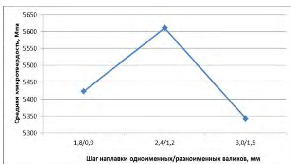
Рис. 5. Зависимость средней микротвердости фазы сплава ПГ-12Н-01 от шага наплавки
