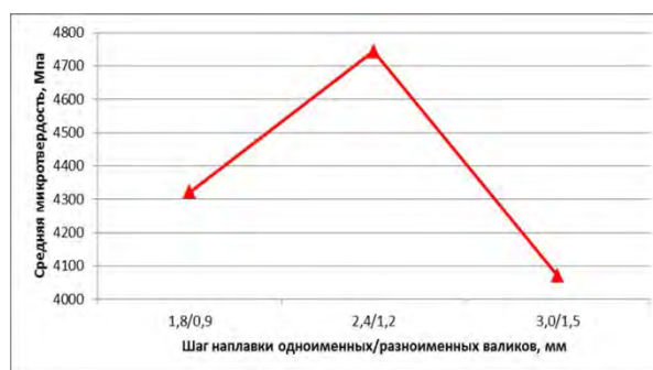
Рис. 6. Зависимость средней микротвердости фазы бронзы ПГ-19М-01 от шага наплавки
