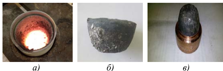
Рисунок 1 – Этапы получения катода-мишени из силицида никеля с титаном: а – металлургическое восстановление; б – слиток силицида; в – катод-мишень на медном токовом
