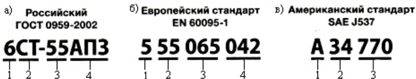
Рис. 6. Идентификационные обозначения АКБ:
