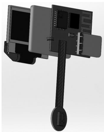
Рис. 1. Твердотельная модель электронного узла пульсоксиметра
