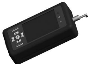
Рис. 1. Твердотельная модель профилографа профилометра
