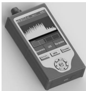
Рис. 1. Твердотельная модель течеискателя газа
