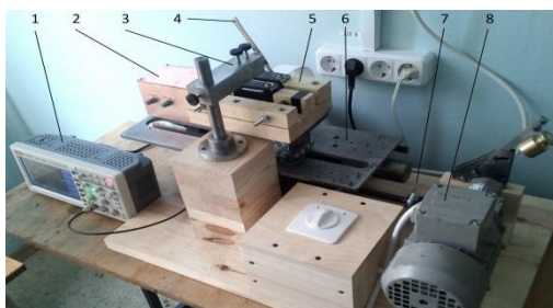
Рис. 1. Устройство проверки остроты режущей кромки медицинских скальпелей
