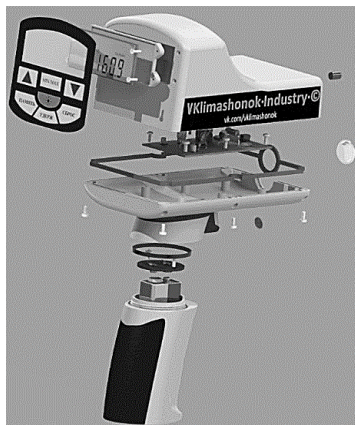
Рис. 1. Твердотельная модель лазерного тахометра
