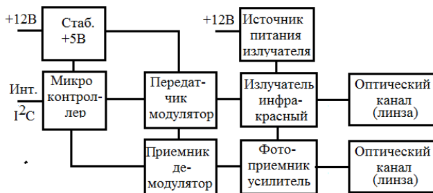
Рис. 1. Схема структурная устройства передачи данных по инфракрасному каналу связи
