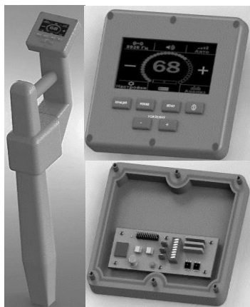
Рис. 1. Твёрдотельная модель кабелеискателя
