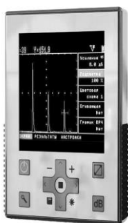
Рис. 1. Твердотельная модель цифрового дефектоскопа
