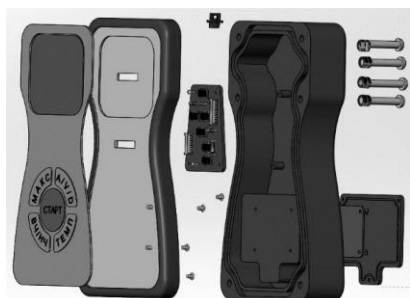
Рис. 1. Твердотельная модель измерителя вибрации
