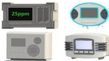
Рис. 2. Твердотельные модели устройства контроля угарного газа
