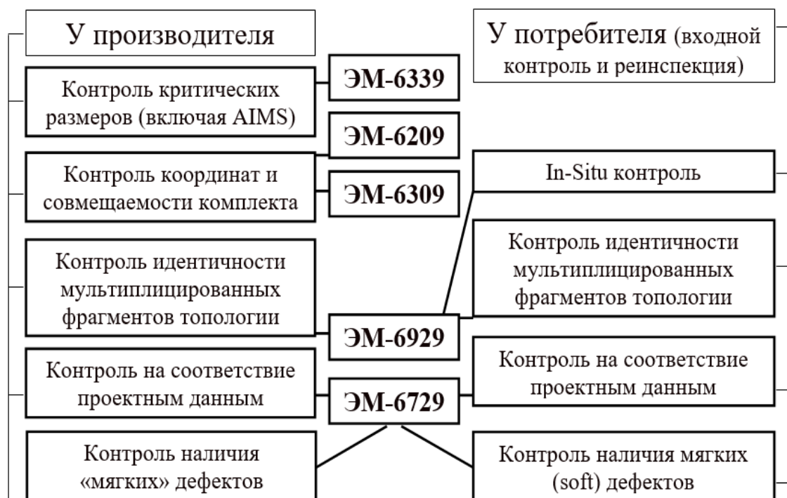
Рис. 3. Виды контроля оригиналов топологии на фотошаблонах
