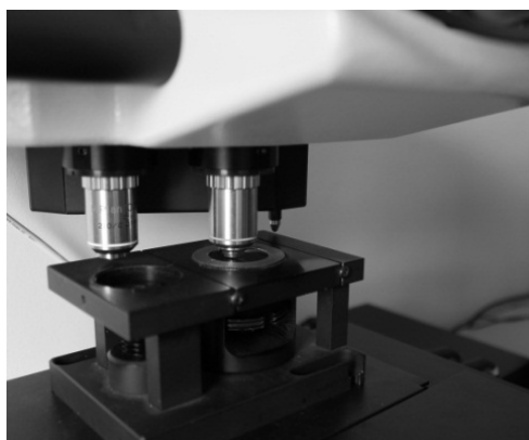
Рис. 3. Результаты измерения микротвердости образцов а – процесс измерения, б – результаты измерений
