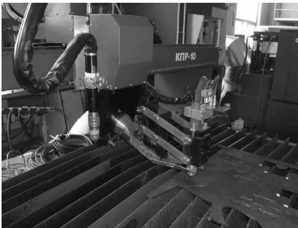
Рис. 3. Система резки под углом криволинейных поверхностей плазменной головкой
