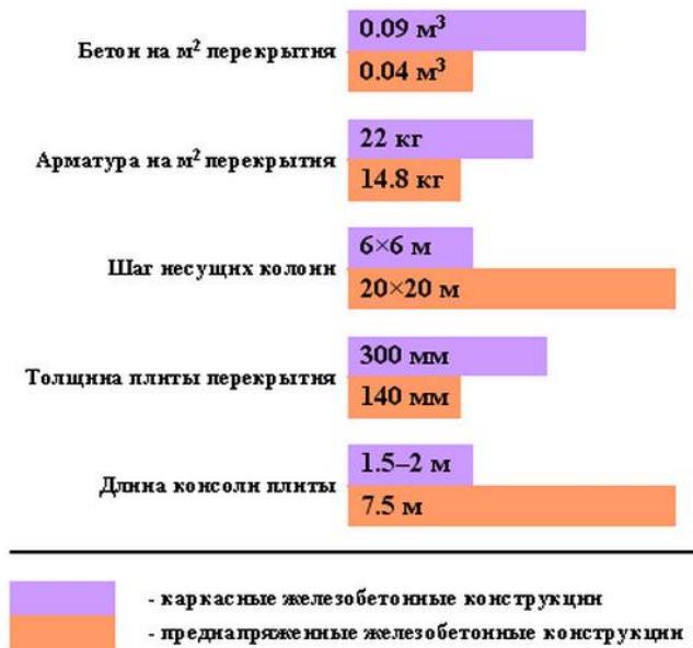
Рисунок 8. Эффект от применения технологии пост-напряжения арматуры по данным ООО «Следящие Тест-Системы» [7]
