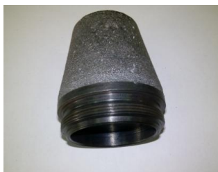
Рисунок 4 – Опытный образец катода-мишени из комплексного силицида на стальном токовом
