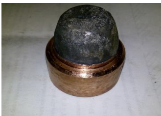
Рисунок 3 – Образец катода-мишени из сплава кремний-никель-титан на медном токовом
