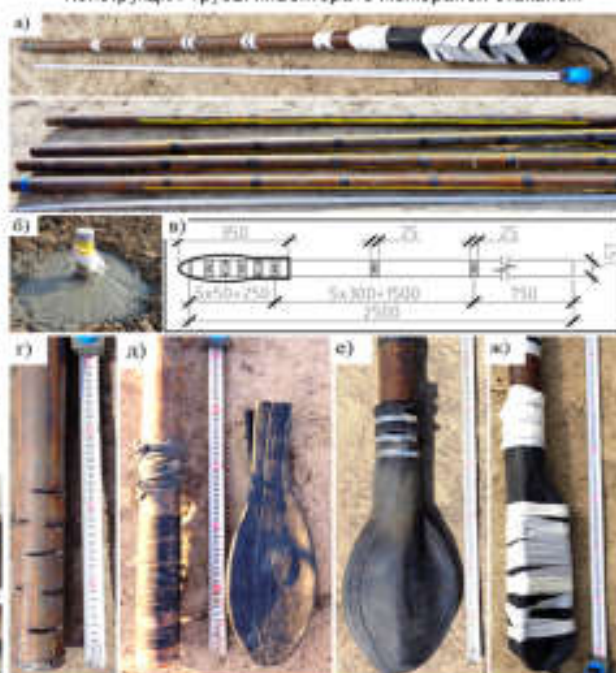
а – собранные инъекторы, б – пробка, в – схема инъектора, г – отверстия перфорации, д – манжеты и резиновая прокладка, е – закрепленная на трубе мембрана-стакан, ж – мембрана перед погружением в скважину.
