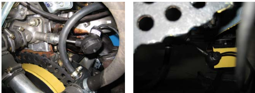
Рис. 11.9. Датчики измерения температуры охлаждающей жидкости (слева) и масла (справа)
