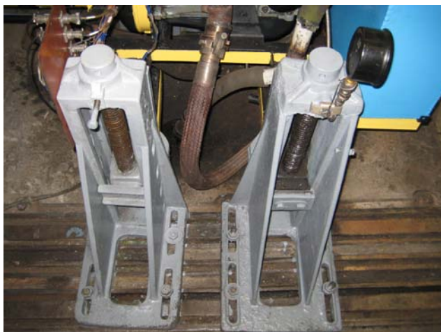
Рис. 11.4. Устройство для установки и крепления двигателя
