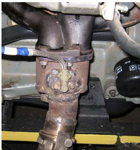
Рис. 11.11. Датчик для измерения температуры отработанных газов
