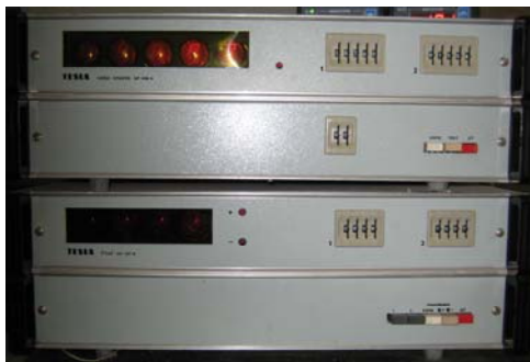
Рис. 11.8. Устройство вывода частоты вращения коленчатого вала и крутящего момента двигателя
