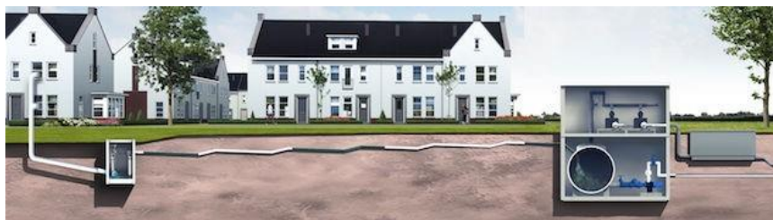
Рисунок 1 – Принципиальное устройство системы вакуумной канализации
